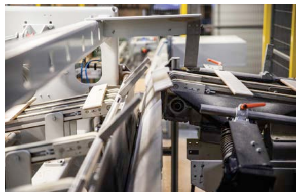
Wie am digitalen Zwilling in Mechatronics Concept Designer (links) vorhergesehen, werden bis zu 360 Bretter pro Minute zuverlässig separiert.
